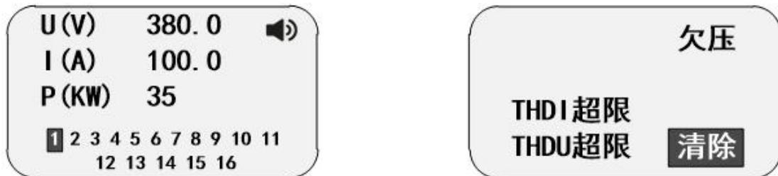
某项参数超限或者不达标，会造成控制器报警(右上角显示喇叭符号)，报警后控制器会对已经投入的回路进行切除，并闭锁控制器输出，需要查看具体的报警后针对性调整某项参数以后控制器才可以正常运行。
